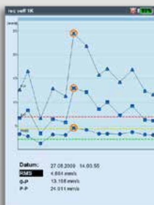
Schwingungskennwerte aufzeichnen (RMS, 0-p, p-p)
