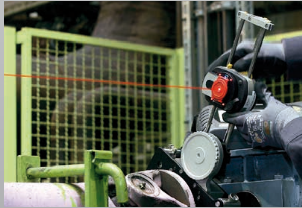
Vermessung einer Kardanwelle im eingebauten Zustand mittels innovativer Messtechnik.
